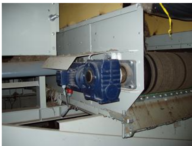
Rys 1: Przykład zabezpieczenia przed pyłem napędu
